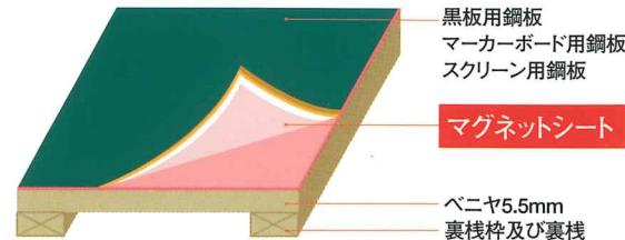
接着剤の代わりにマグネットシートを使用。鋼板とベニヤの分離が簡単にでき、リサイクルに対応。ベニヤや枠を再利用した、色や仕様の変更も簡単にできます。
