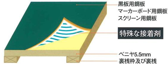
特殊な接着剤で鋼板とベニヤを貼り合わせているため、解体時の分離が難しく、リサイクルへの障壁となっています。
